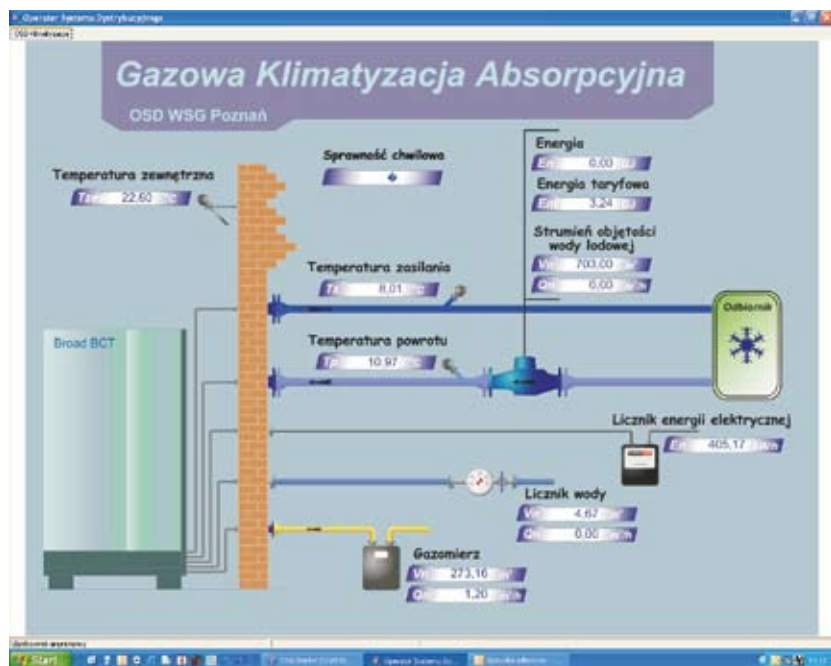
Rys. 7. Wizualizacja parametrów pracy absorpcyjnego urządzenia klimatyzacyjnego na ekranie monitora.
