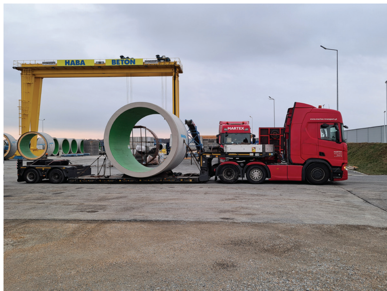
Z uwagi na tonaż na jednym pojeździe mogła być przewożona tylko jedna rura przeznaczona na budowę kolektora Wiślanego. Fot. HABA-Beton Johann Bartlechner Sp. z o.o.
